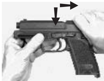
Lage Aussparung zu Verschlussfanghebel Position of the recess of the slide release
