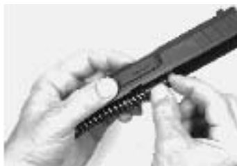
Pufferstange, vollst. einlegen Insert the recoil / buffer spring guide rod
