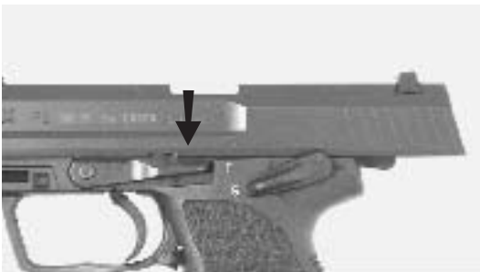
Verschlussfanghebel drücken Press slide release downward
