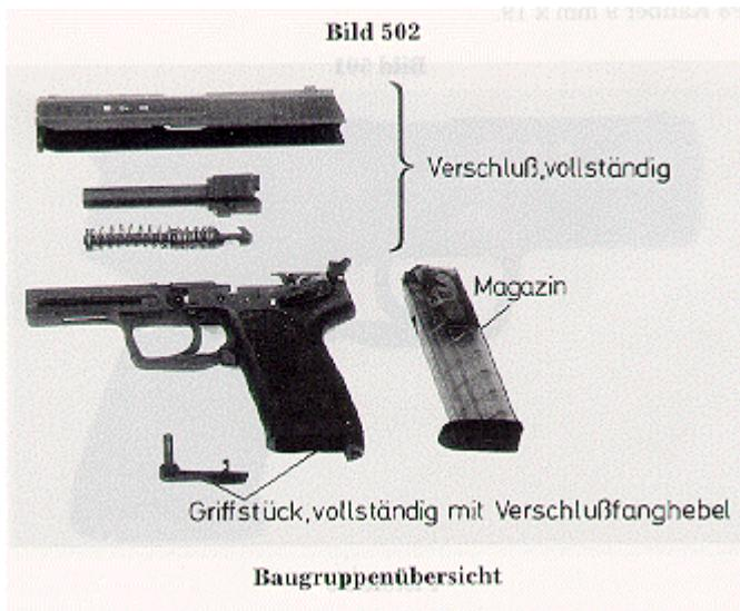
504. Der Verschuß (Bild 503) nimmt das Rohr auf, verschließt es nach hinten, führt die Patrone zu, zündet sie mit dem Schlagbolzen und zieht die Hülse mit dem Auszieher wieder aus. Der Verschuß ist mit dem Rohr und dem Griffstück durch die Führungsleisten am Rohr und mit den ausgefrästen Führungen an Verschuß und Griffstück gleitend verbunden.
