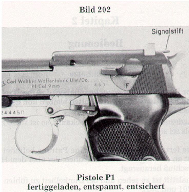
204. Der Abzug kann bei der entsicherten Pistole mit gespanntem und auch mit nicht gespanntem Hahn zurückgezogen werden.
