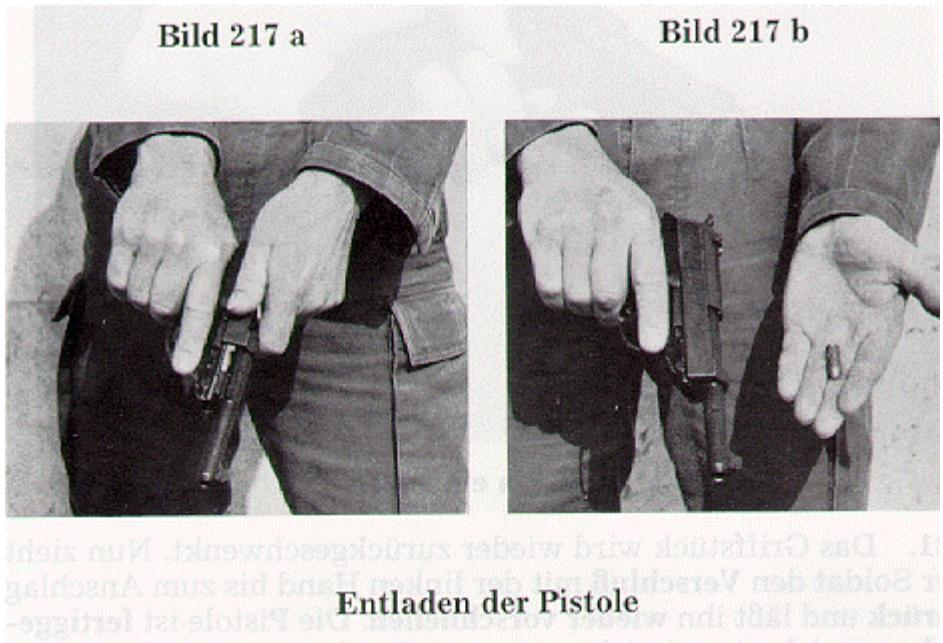
225. Beim Entladen einer teilgeladenen Pistole ist nach dem Entfernen des Magazins der Verschuß zurückzuziehen und zu prüfen, ob das Patronenlager frei ist.
