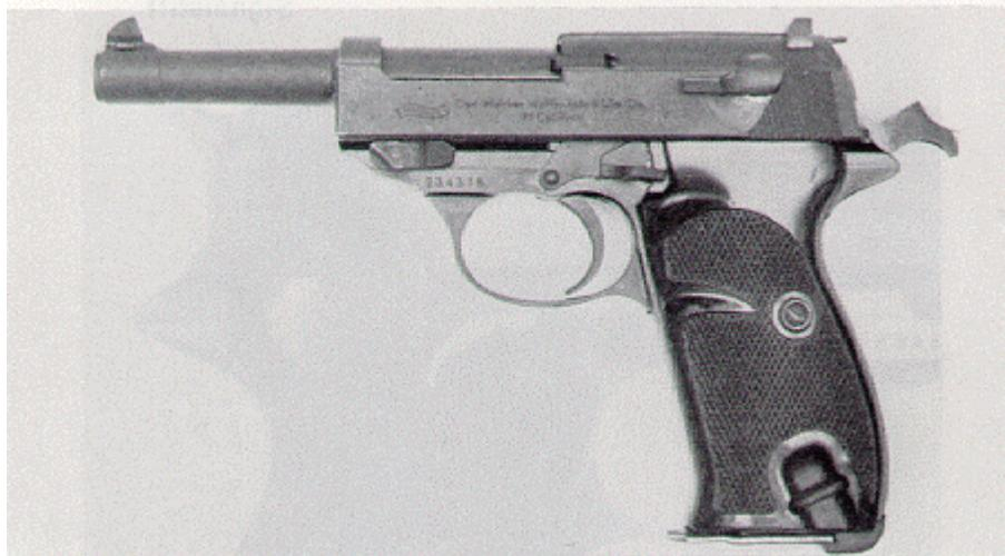
**Pistole fertiggeladen, gespannt und entsichert
