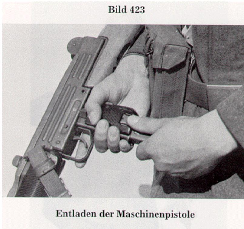
Der Soldat prüft, ob das Patronenlager frei ist. Dazu drückt die rechte Hand am Griffstück die Griffsicherung ein und setzt sie außer Funktion, während er mit der linken Hand den Verschuß mittels Spanschieber in seine hinterste Stellung zieht.
