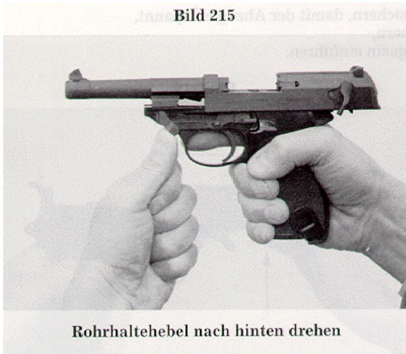
Nach dem Zusammensetzen ist die Funktion der Pistole zu prüfen. Dazu nimmt der Soldat das Magazin und zieht den Verschuß der Waffe mehrmals zurück und läßt ihn wieder nach vorn gleiten.
